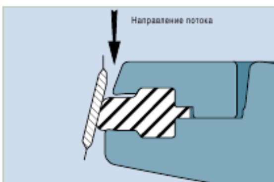
Уплотняющая манжета JPAi в положении «закрыто» Установка ось вращения диска вниз по течению
