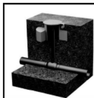
Подземный кран, установка над землей
